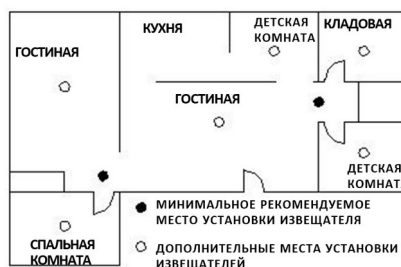
Рисунок 4 – Схема расположения Извещателей с спальнями в разных зонах
