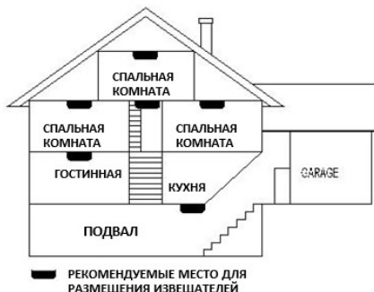
Рисунок 5 – Схема расположения Извещателей в многоэтажном жилом здании
